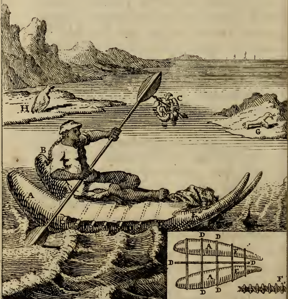
A Plan d'une Balse faite de peaux de loups marins cousues et pleines d'air. B. Indien sur une Balse vue de Cote' C. autre vue de front D. Traverses pour rassembler les deux moities de la balse E trou pour l'enfler et la remplir d'air. F. maniere de Coudre les peaux. G. Loup marin a terre H Pingouin.
