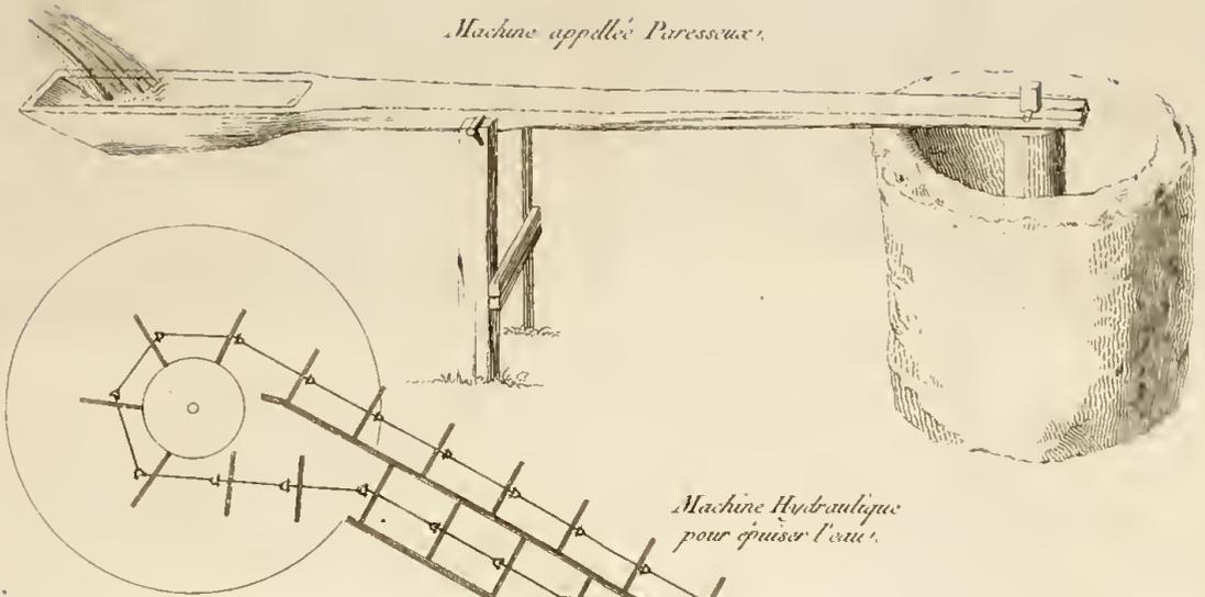
*Machine Hydraulique pour épuiser l'eau.*
